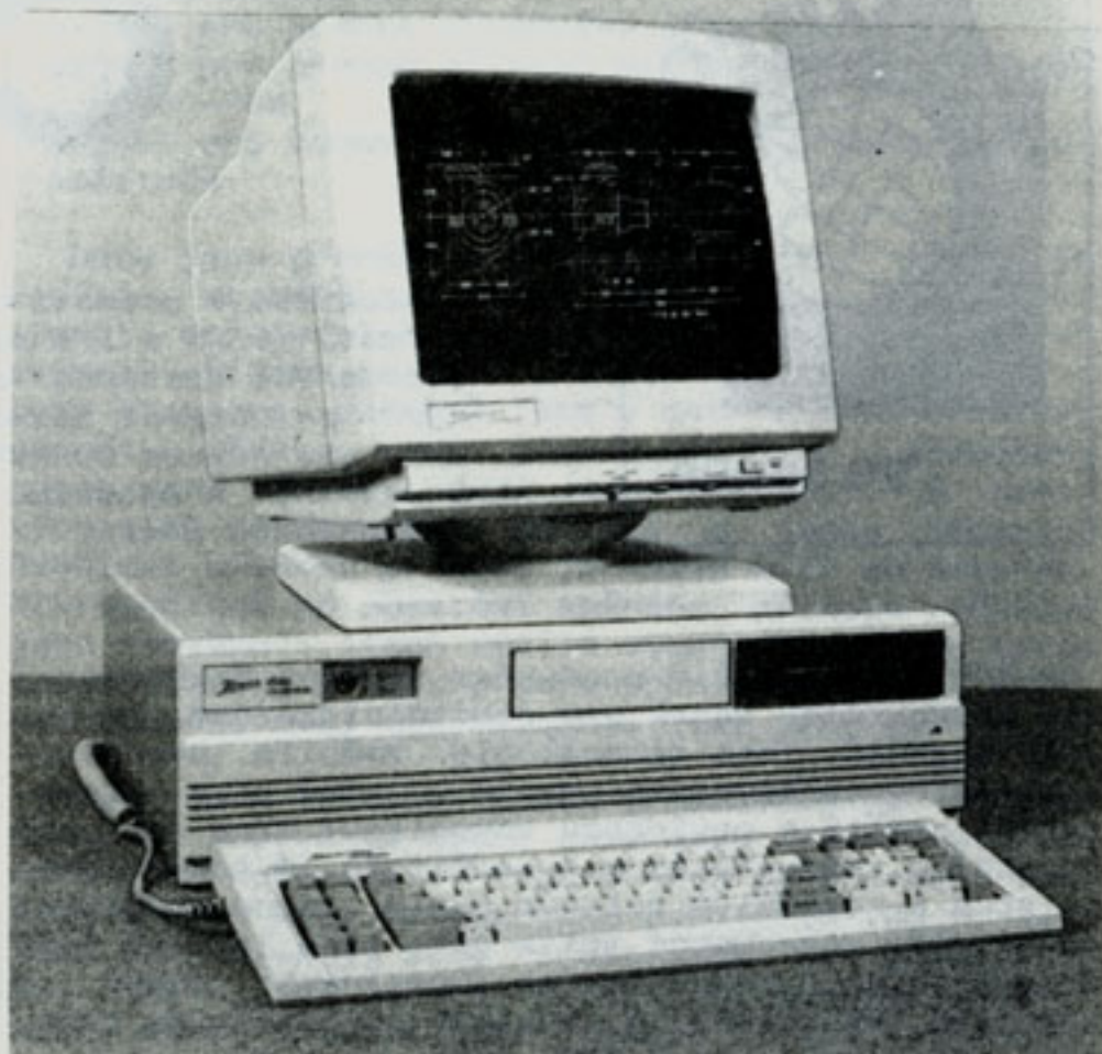
Obr.4 Jeden z mnoha silných konkurentů IBM - model Zenith Z-386, založený na 32-bitovém mikroprocesoru I 80 386, který má výkon mezi 3 a 4 milióny instrukcí za sekundu.
