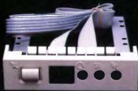
Moduł IrDA do łączności w paśmie podczerwieni
