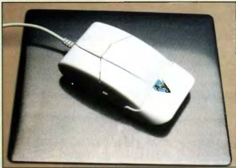
5. Optical WinMouse razem ze specjalną podkładką podzieloną na setki drobnitkich krątek. Mysz ta wyposażona jest w parę czułych oczu zliczających mijane kratki na podkładce.
