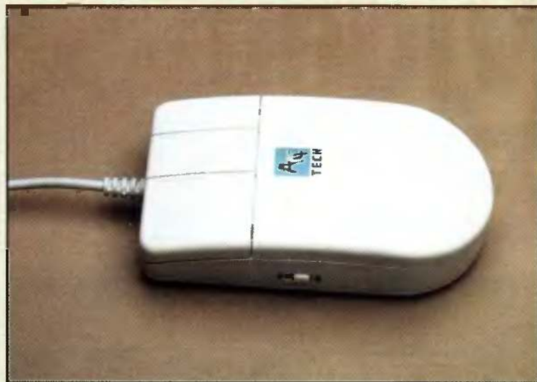
1. Model AM-5E – klasyczna myszka optomechaniczna.
