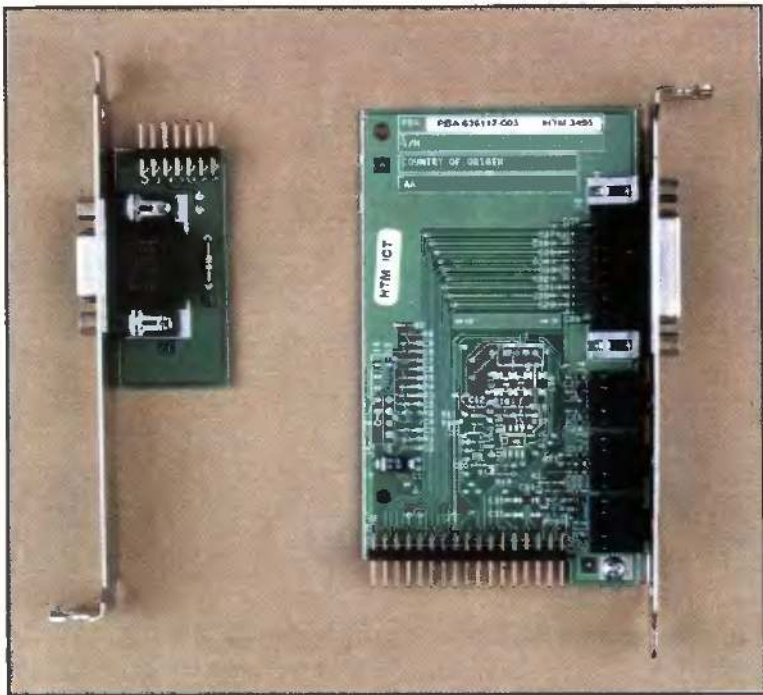
Te dwa małeństwa pozwalają podłączyć do płyty monitor (moduł po lewej) oraz mikrofon, głośniki i joystick (moduł po prawej stronie).
