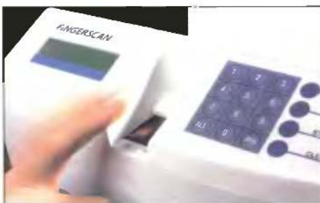
FingerScan – identyfikacja osób wykorzystująca trójwymiarowy wzorec palca.
