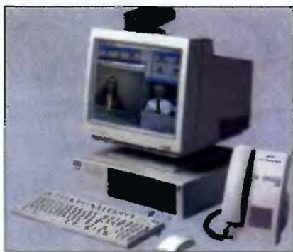
System wideokonferencji za pośrednictwem łączy cyfrowych centrali Hicom 300
