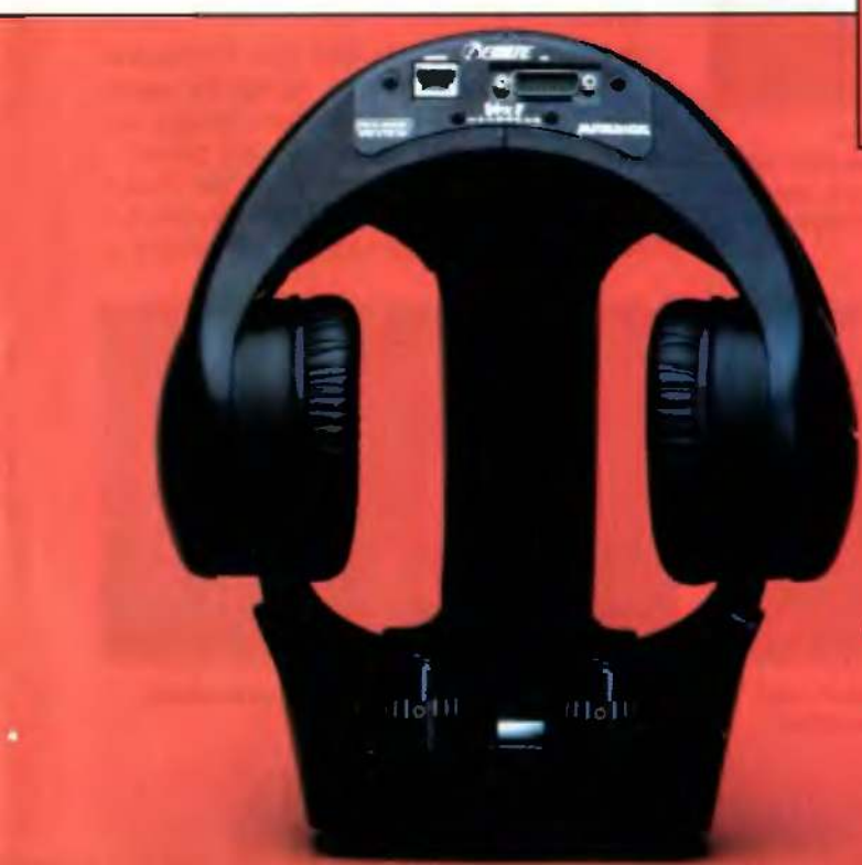
VFX1 „od podszewki” – widoczna jest podziałka od regulacji ostrości oraz dwa gniazda: 26-pinowe na kabel łączący z komputerem oraz ACCESS bus na CyberPuck-a.
