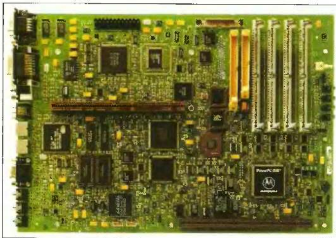
Płyta główna Ultra 603. W prawym, dolnym rogu widoczny jest, wsparty na 304 nóżkach, procesor MPC603, taktowany zegarem 66 MHz.
