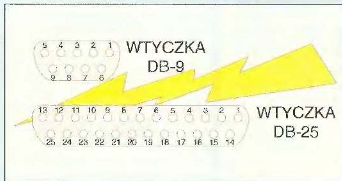
Układ wyprowadzeń na wtyczkach DB-9 i DB-25
