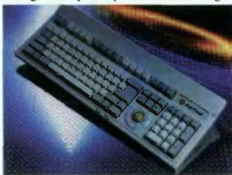
Trackball zintegrowany z klawiaturą
