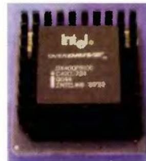
Procesor Intel 486DX4 można rozpoznać po rozbudowanym radiatorze
