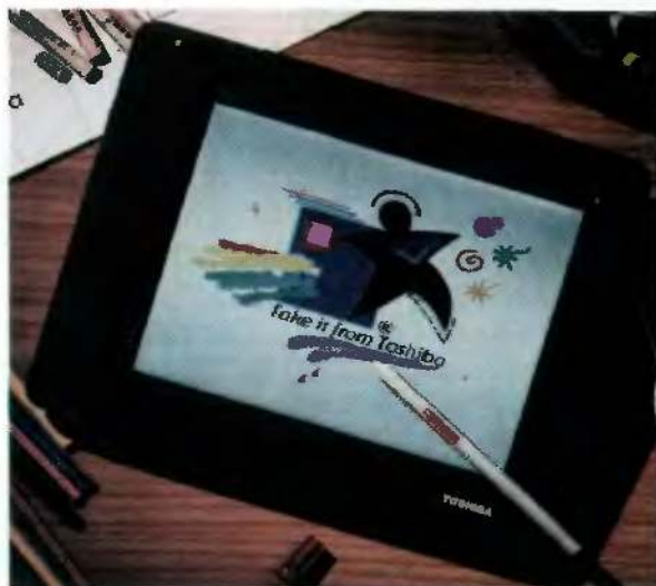
Toshiba Dynapad T200, przedstawiciel „ryśkowców” (i486DX2 40 MHz, HD 80 MB, 4 MB RAM, 2xPCMCIA, ekran kolorowy)
