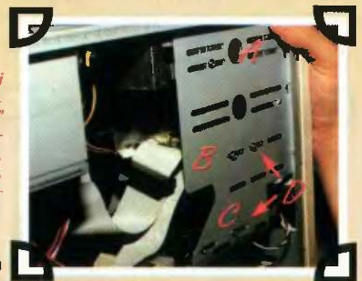
– Dyski wmontowane. A - stacja 5,25” jako A.; B - stacja 3,5” jako B.; C - dysk twardy, D - wkręty mocujące).
