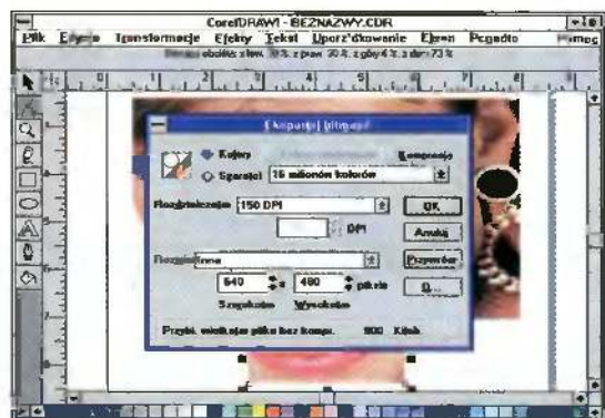
Gdy eksportujemy bitmapę, to możemy ustalić szereg jej parametrów np. rozmiar i rozdzielczość.
