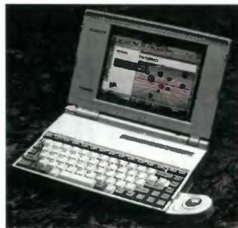
Toshiba T4800CT – i486DX4 75 MHz, HD 500 MB, 8 MB RAM, ekran TFT 256 kolorów z kartą Local Bus, 2xPCMCIA, Microsoft Sound System
