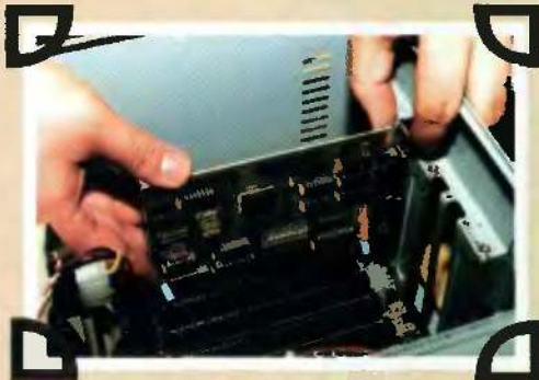
– Montaż karty Multi I/O do slotu
