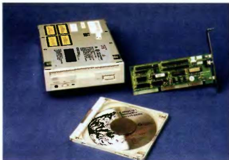
Napęd Matsushita CR-522-B. Jest to typowy napęd Single Speed wraz z kontrolerem AT-BUS. Na zdjęciu widoczna jest też kasetka, tzw. „caddy” z włożoną płytą.
