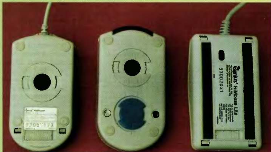
Typowa mysz mechaniczna. U dołu widoczny przełącznik między trybem pracy MS Mouse i PC Mouse.
