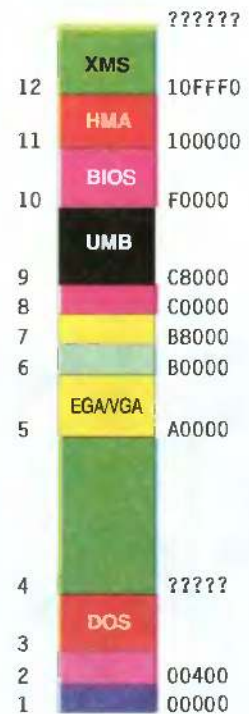
Podstawowe informacje o pamięci operacyjnej w programie SYSINFO.EXE z pakietu Norton Utilities 7.0.
