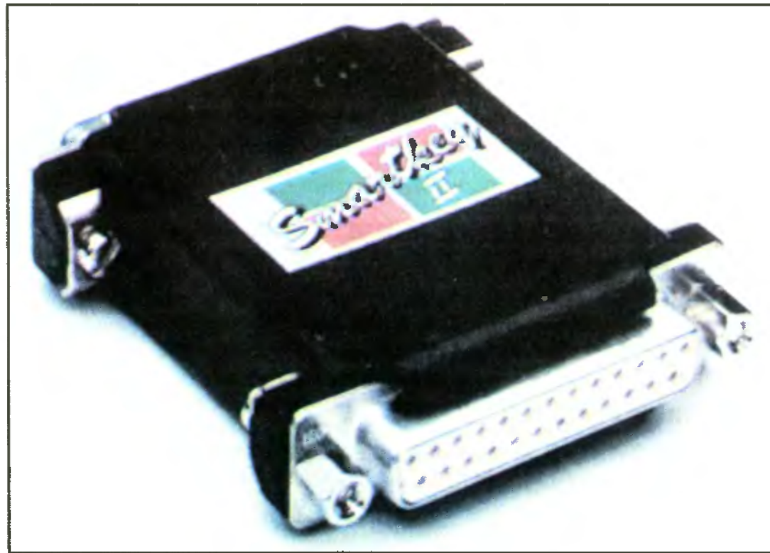
Moduł SmartKey-II/EP z systemem monitorującym każdą nielegalną próbę dostępu do oprogramowania
