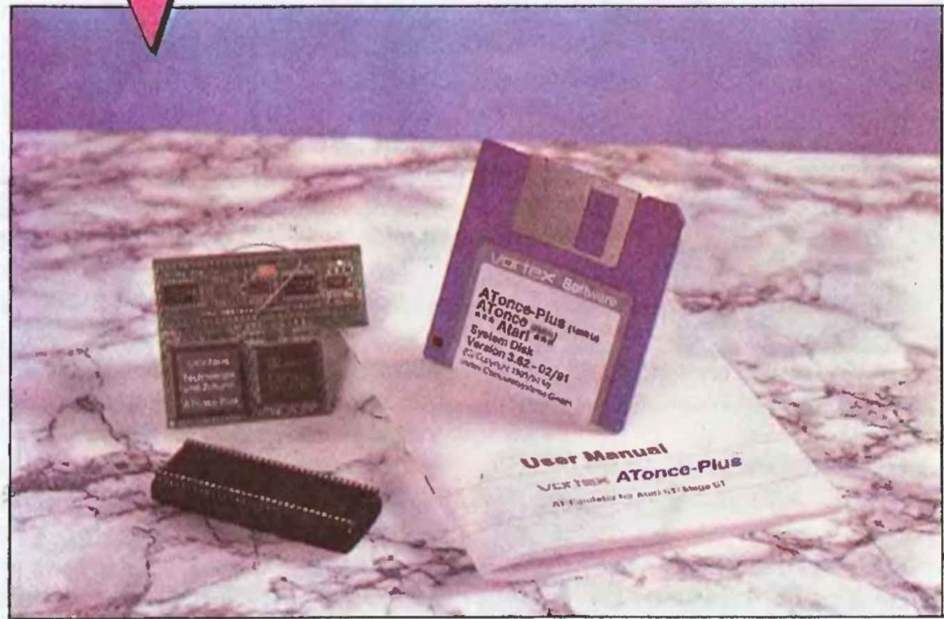
Komplet emulatora ATonce-Plus zawiera podstawkę, płytę emulatora, dyskietkę systemową i instrukcję.
