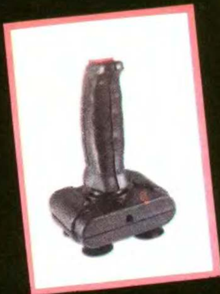
TURBO JUNIOR 2: 4 Mikroprzełączniki, 1 przycisk fire, Najtanszy joystick na mikroprzełącznikach.
