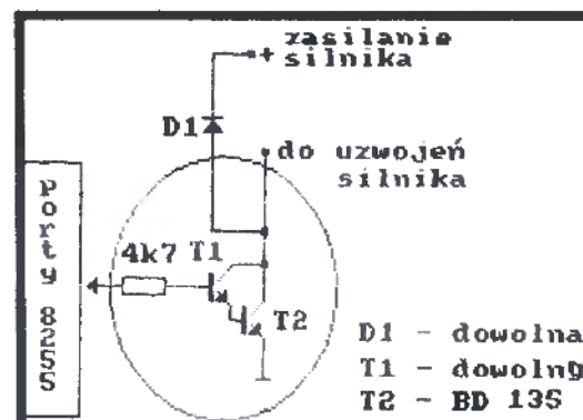
Rys. 3 Przykład klucza włączającego jedno uzwojenie (fazę).
