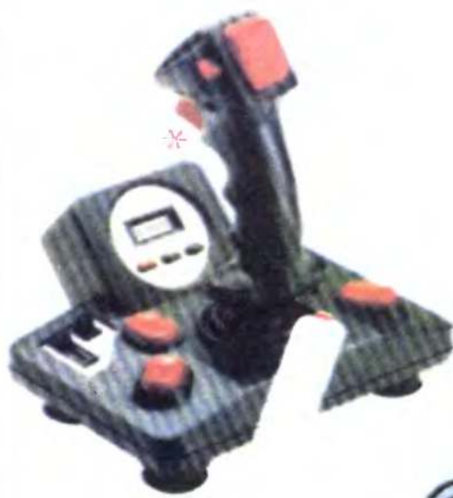
SV 125 Superboard 6 Fire 10 Mikrostryków AutoFire Cyfrowy wyświetlacz czasu Sygnał dźwiękowy Przełącznik dla leworecznych Drażek lotniczy
