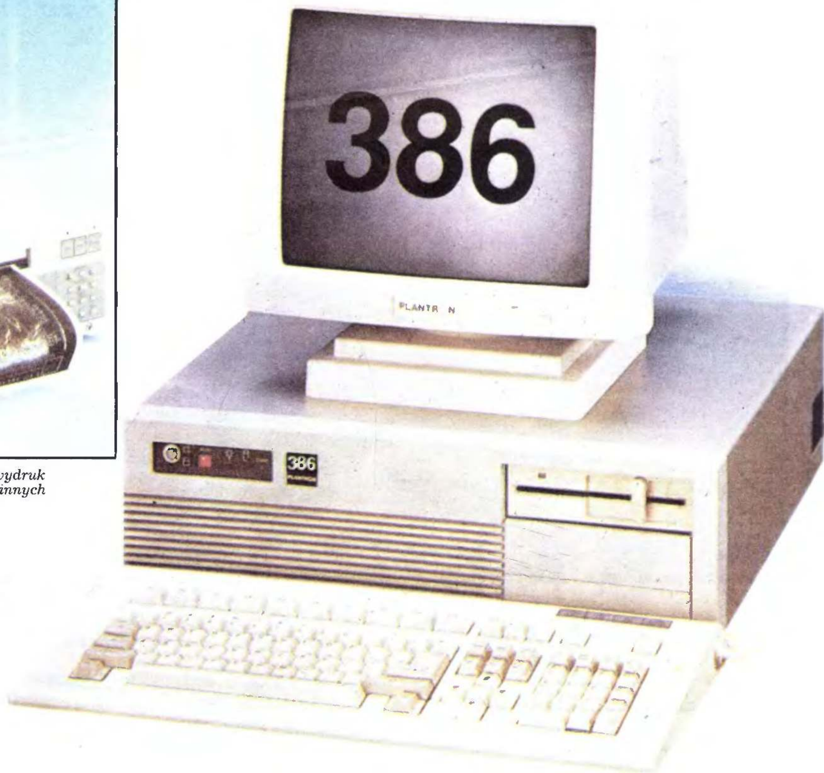
Komputer Plautron PT-386: procesor 80386 z zegarem 16 MHz system operacyjny MS-DOS 3.2
